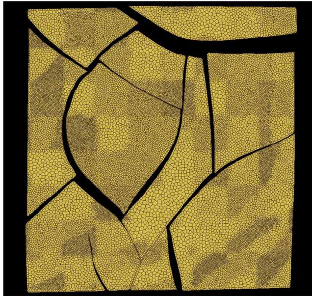
**Figure 7.14** Un exemple de maillage de référence constitué de polygones quelconques obtenus par dual d'une triangulation de Delaunay (modèle TOTAL). Le maillage a été raffiné en fonction d'une propriété aléatoire définie sur une grille régulière très grossière (voir partie 5.2). Noter le respect des bords.
