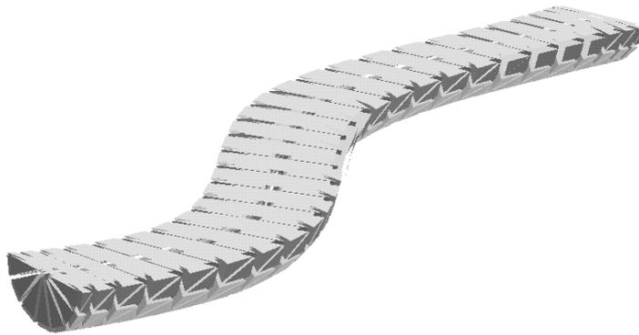
FIGURE 1-4 : Un exemple de T-Solid ou volume
